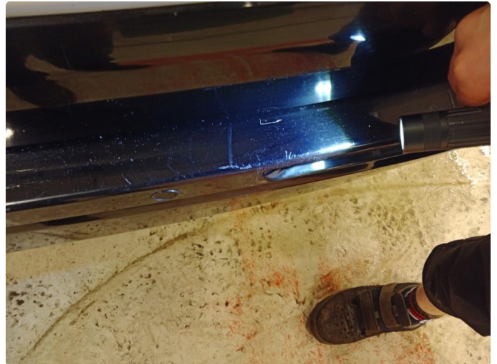
1.3 Riper på innlastigsone til bakfanger
