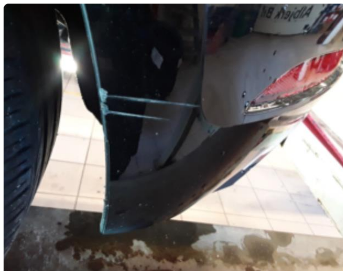
1.1 Div stensprut,riper, lakkskader i karosseriet m/rustdannelse.
