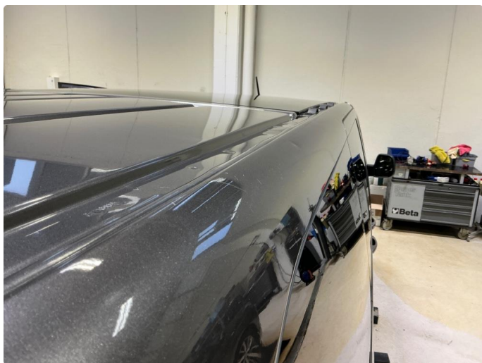
2.9 Takvange høyre side - flere bulker
