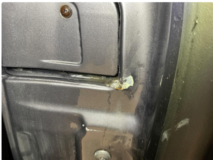
2.5 Høyre skyvedør bak , slitt gjennom lakk
