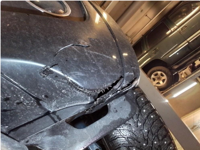
1.2 Liten sprekk i underkant av forfanger
