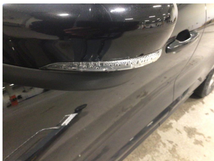
1.2 Fukt i blinklys glass på speiler begge sider
