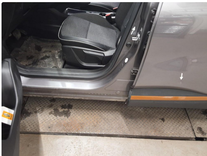
1.5 Riper innvendig i døråpning
