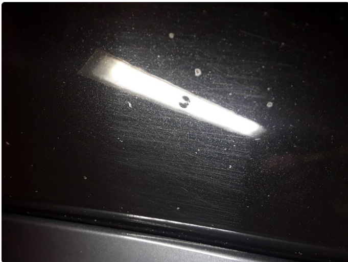
1.2 Liten steinsprut med korrosjon venstre fordør.
