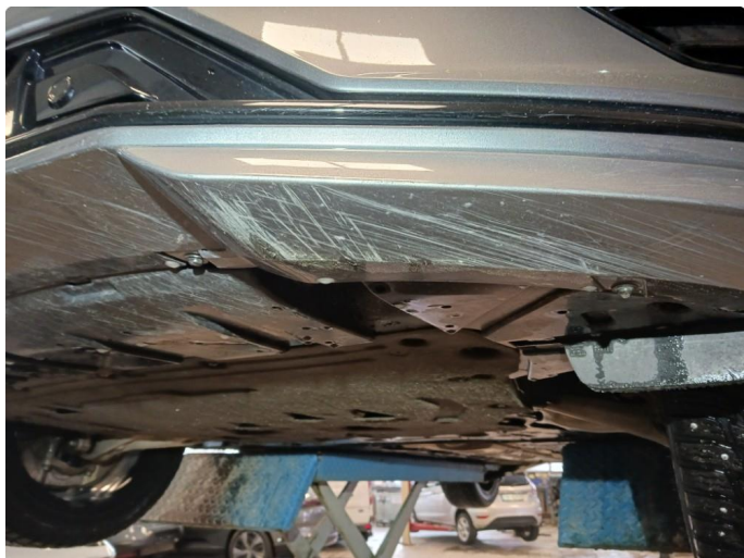
1.2 Skrubbeskade underkant støtfanger foran
