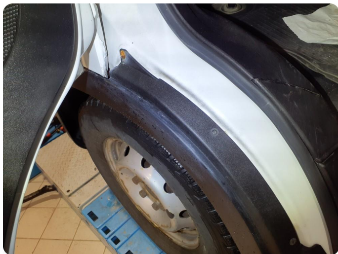
3.4 Ufagmessig utført arbeid
