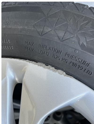
1.1 Bruksmerke på fel- anses som normal bruksslitasje
