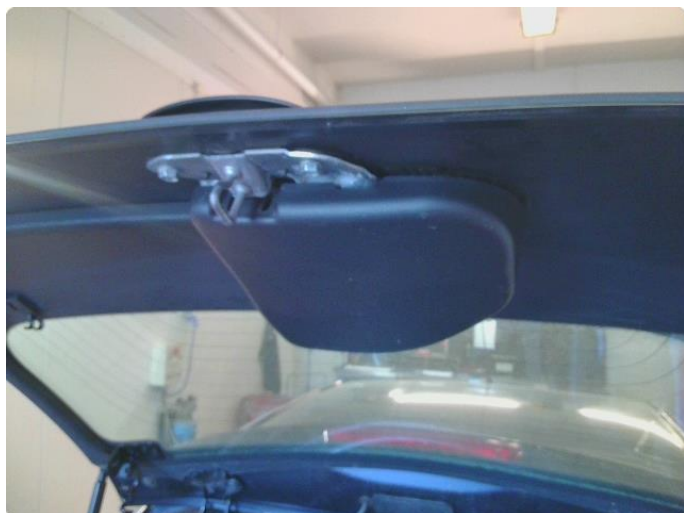
2.2 Dekksel inside bakluke er løs
