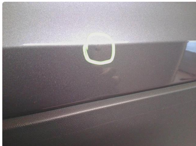
1.2 Steinsprut med rust
