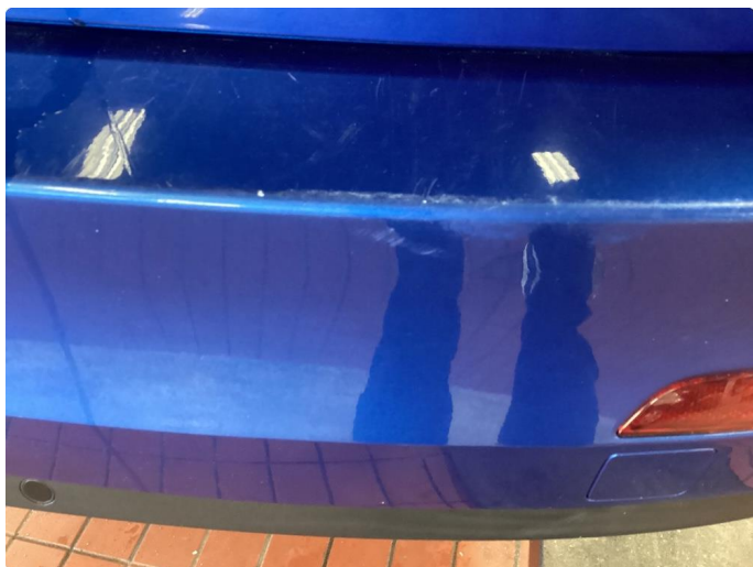
3.1 Normal slitasje etter alder å dømme
