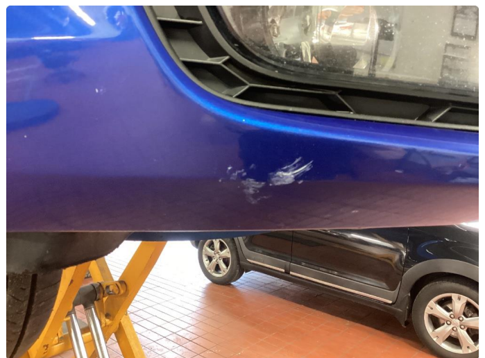
1.3 Noe små skader på støtfanger foran
