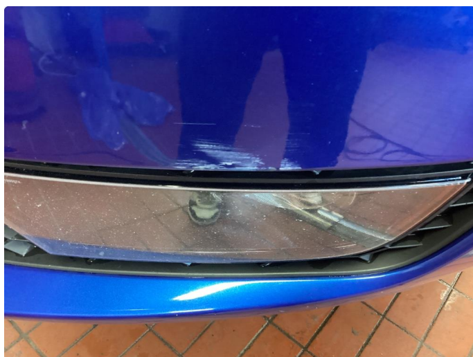
3.1 Normal slitasje etter alder å dømme
