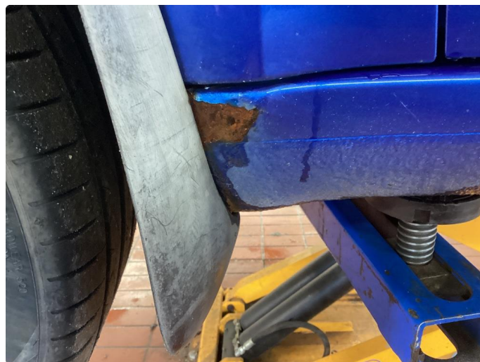
1.4 Litt rust og en liten skade
