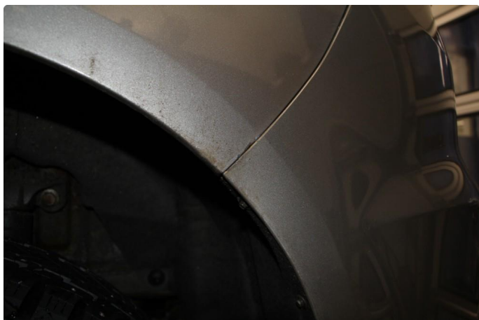
1.3 Rust i hjulbuer og i overgang mellom skjerm/støtfanger. Fanger ligger ikke fint mot skjerm.
