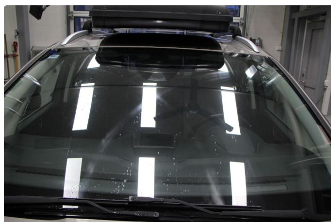
1.6 En hel del sliteriper i glass etter dårlige viskerblad.
