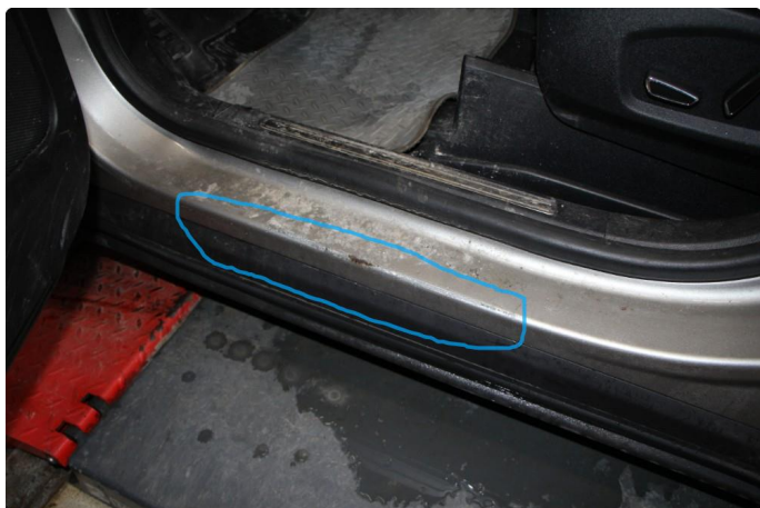
1.2 Lakkslitasje i innsteg.
