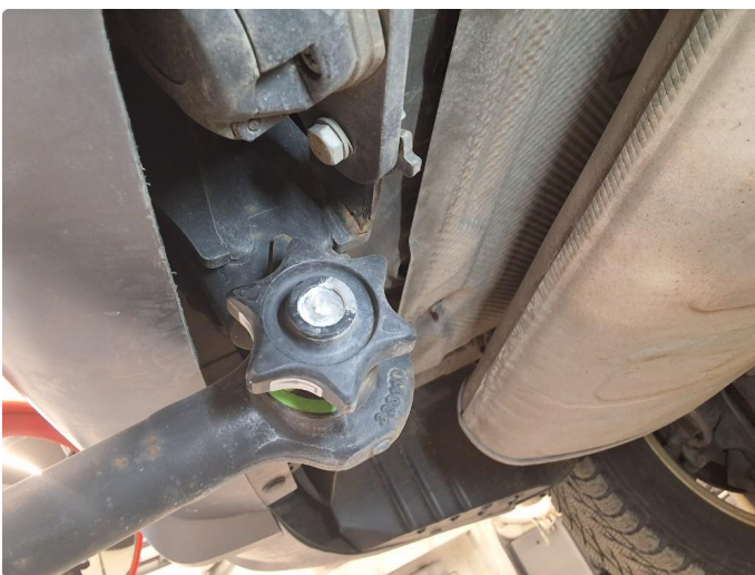
1.3 Låsesylinder defekt, får ikke av avtagbart feste
