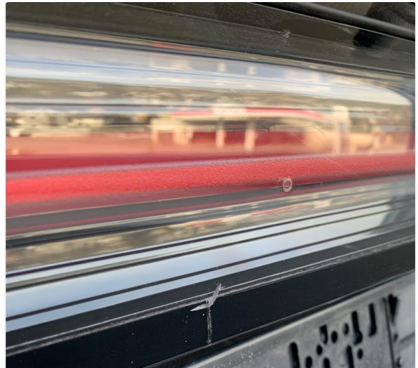
2.1 Liten sprekk i midtre baklampe.
