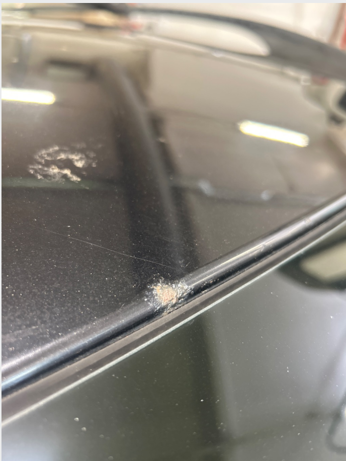
2.14 Noe rust rundt om i karosseri
