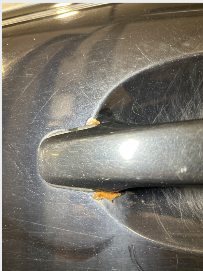
2.14 Noe rust rundt om i karosseri
