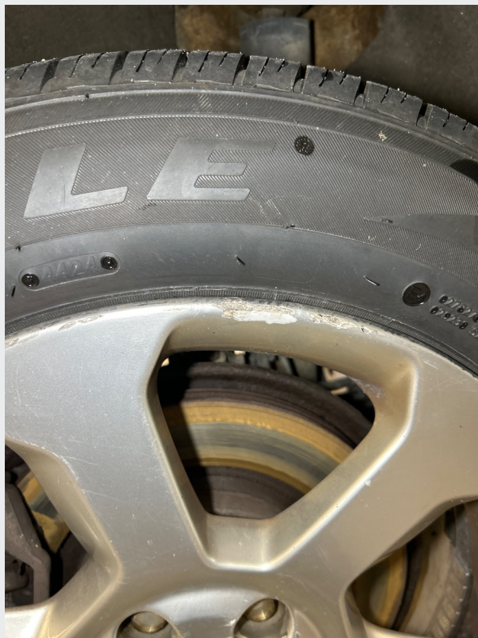
2.18 Noe skade på felger
