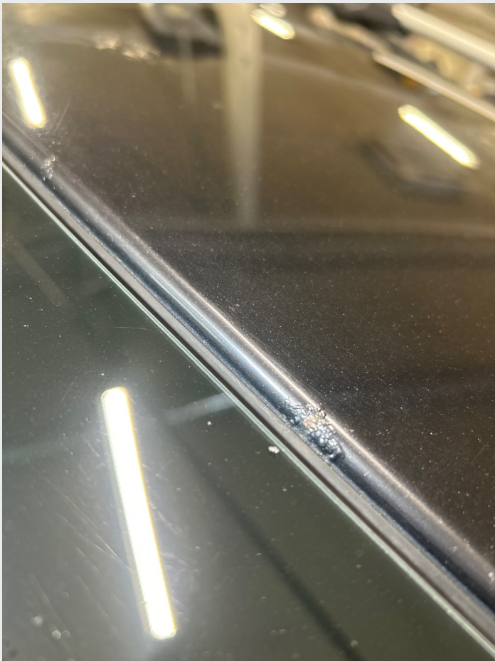
2.14 Noe rust rundt om i karosseri
