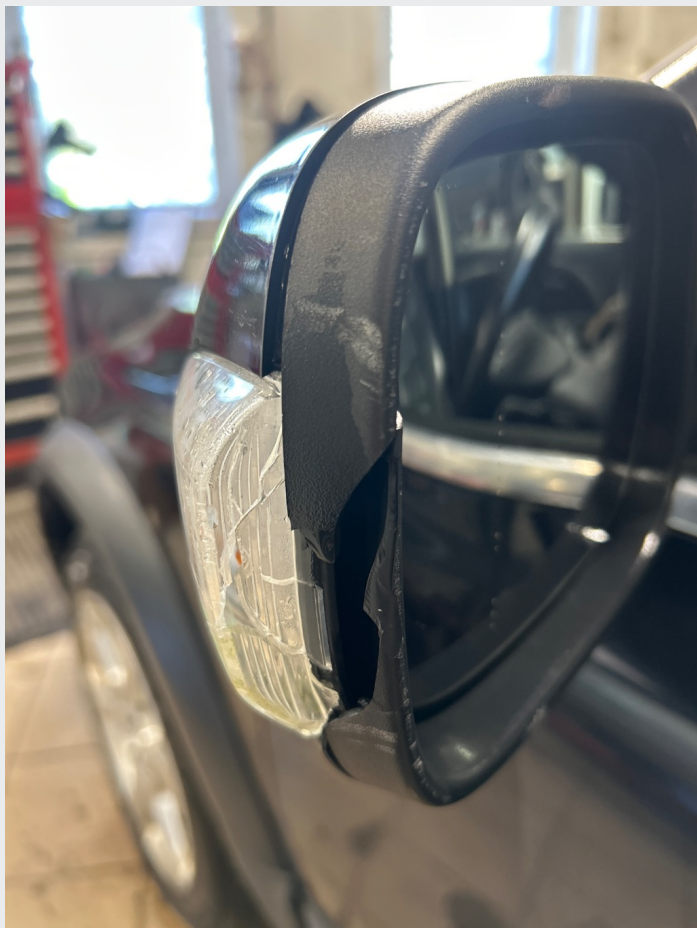
2.12 Sprekk i speildeksel venstre side
