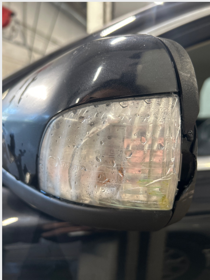
3.4 Sprekk og fukt i blinklysykt i speil venstre side
