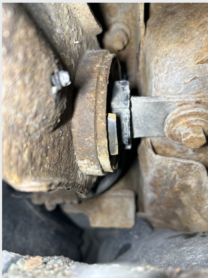
8.5 Fremste foring i bakstilling begge sider har begynt å slippe
