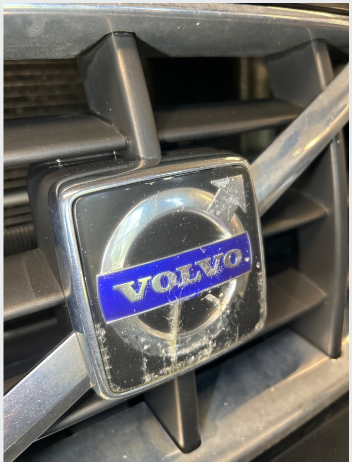
2.8 Sprekk i «Volvo» merke i grill
