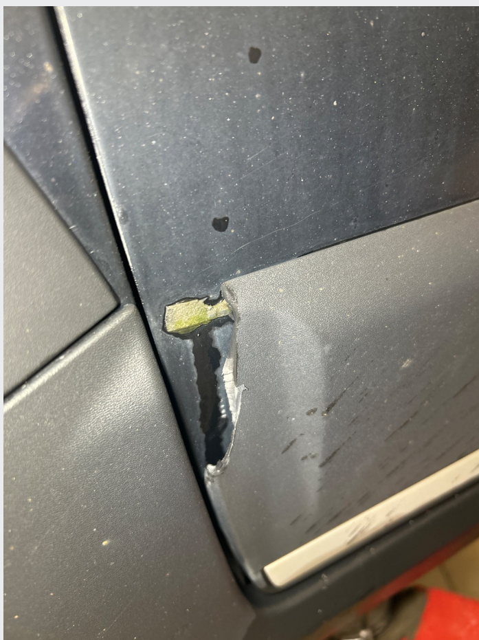
2.5 Sprukket deksel på førerdør
