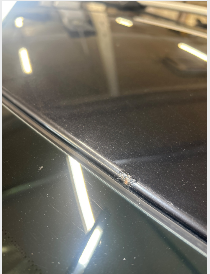
2.14 Noe rust rundt om i karosseri
