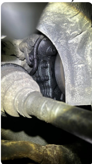
4.5 Oljelekkasje i forkant Tetning veivaksel.
