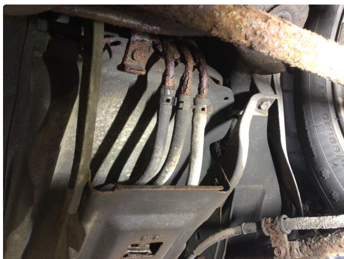
2.1 Rust på drivstoffrør
