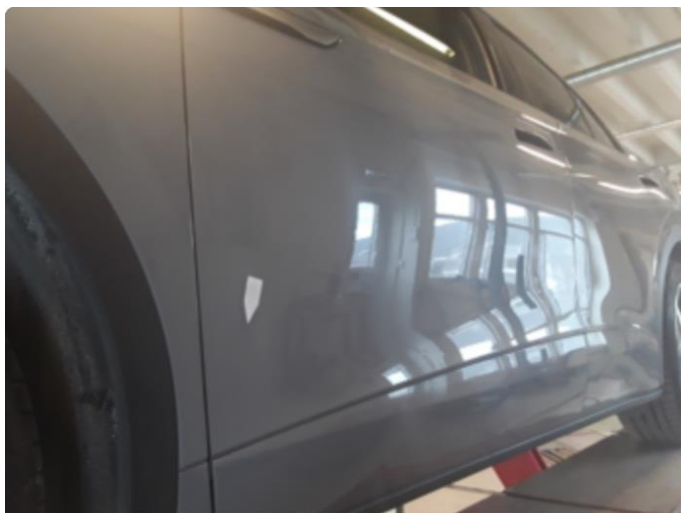
1.2 Liten steinsprut med korrosjon venstre fordør.
