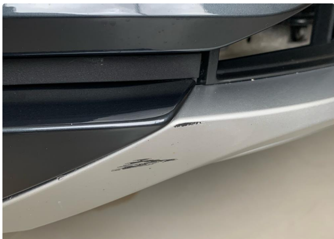
1.2 Noe riper støtfanger foran nedre del høyre side.
