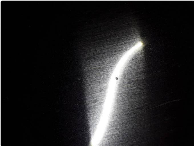
1.2 Liten steinsprut med korrosjon venstre foran.
