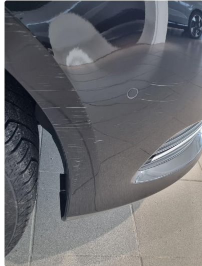
1.2 Riper på siden av frontfanger, høyre foran
