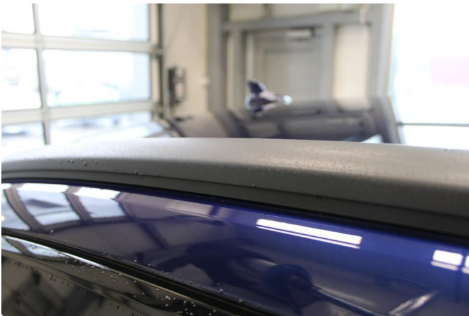
1.3 Noe skjolder på begge takrails
