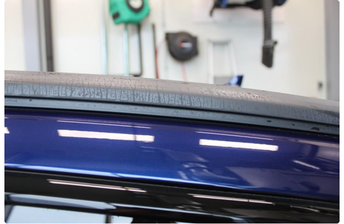
1.3 Noe skjolder på begge takrails
