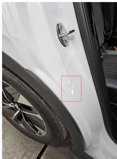
1.1 Bulk (uten lakkskade), h.side bak
