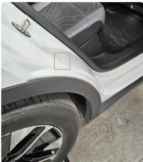
1.1 Bulk (uten lakkskade), h.side bak
