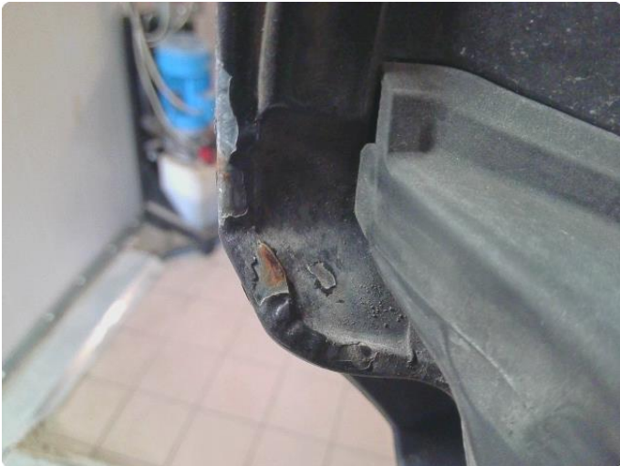
1.1 Rust i fals
