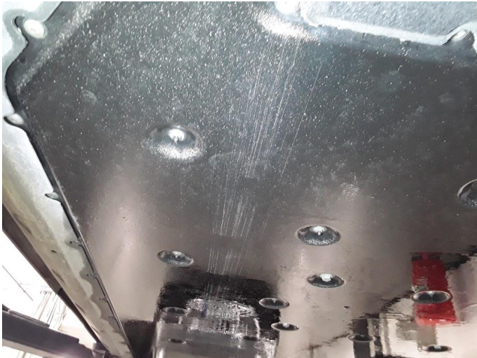
1.1 Noen riper på beskyttelsesdeksel under bilen. Ingen deformasjoner. Normal bruksslitasje
