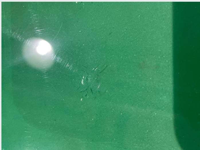
2.15 en liten steinsprut
