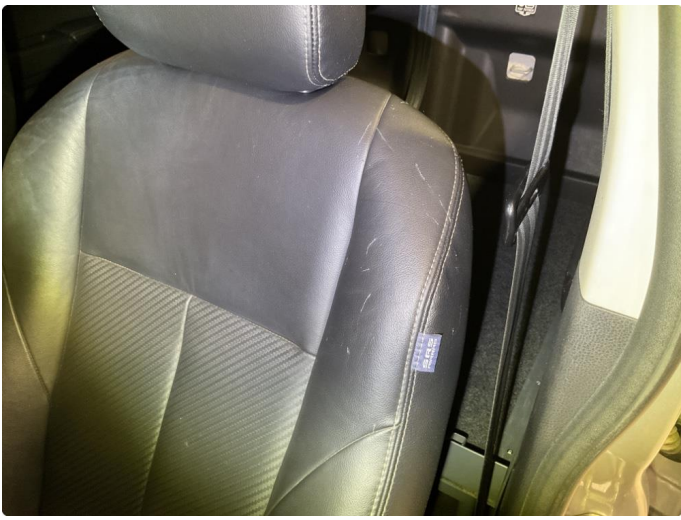
3.1 Skade på setetrekk
