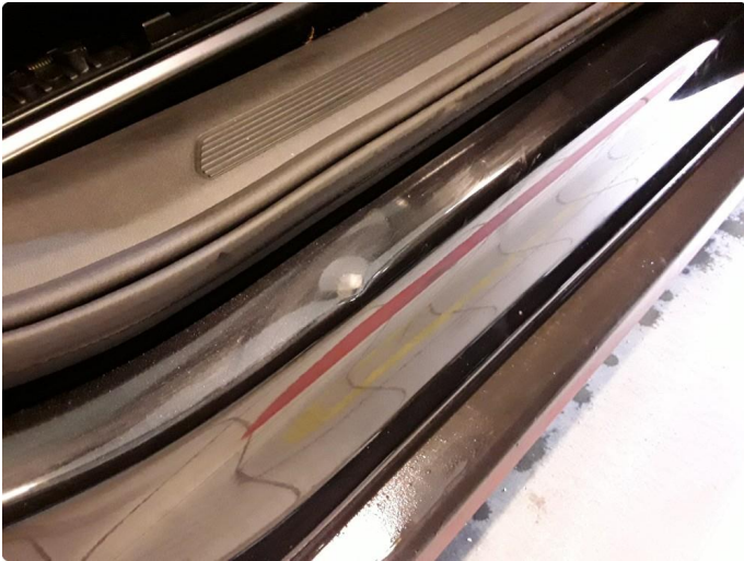
1.2 Liten bulk høyre foran. Blir forsøkt med bulkfix.
