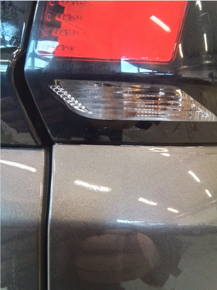
3.2 Flere sprekker innvendig i ytre lykt hb
